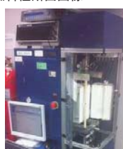
過電圧測定装置
